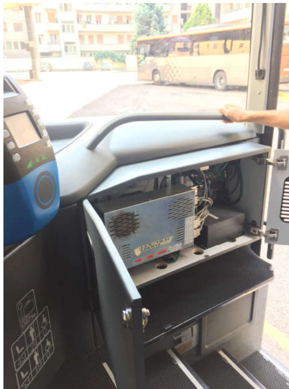
Abbildung 32: Schnittstellenbox an Bord von LiBUS-Fahrzeugen, die mit dem Telematik ITCS-System ausgestattet sind.
