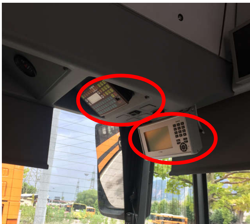
Abbildung 29: Das Aesys KC640 Steuergerät (links) sowie die ITCS Konsole (rechts) auf einem SASA-Fahrzeug.
