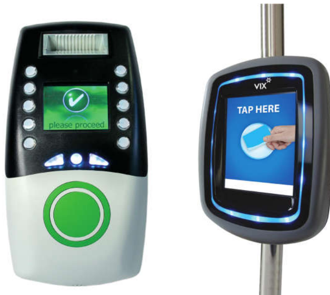
Abbildung 25: Entwerter für die Validierung von Fahrscheinen. Entwerter VIX V6000 mit Doppeltechnologie für Contactless- und Magnetkarten (links), Entwerter VIX CP6500 für Contactless-Tickets (rechts)
